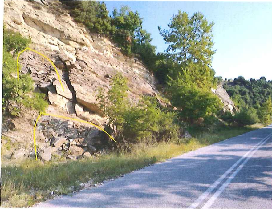
Εικόνα 8.: Κώνοι κορημάτων στο πρώτο σημείο κατολίσθησης.
