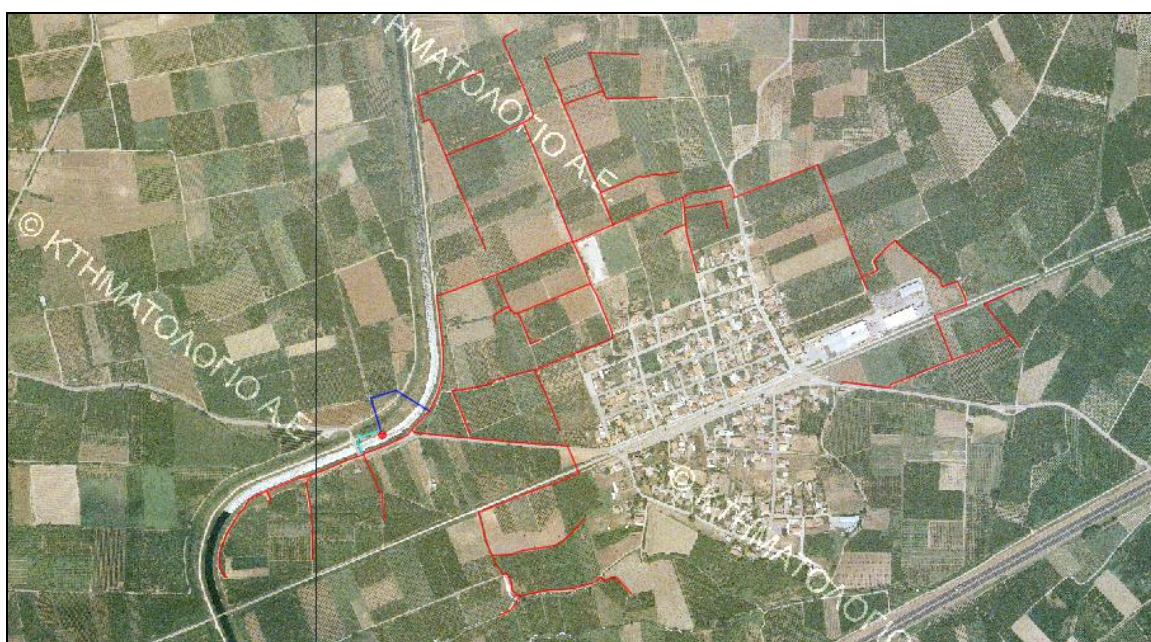
Σχήμα 3.1: Οριζοντιογραφική χάραξη του δικτύου άρδευσης. Με κόκκινο χρώμα παρουσιάζονται οι αγωγοί του δικτύου άρδευσης σύμφωνα με τη χάραξη της μελέτης του Δήμου, με μπλε χρώμα το τμήμα της χάραξης που τροποποιείται λόγω της αλλαγής της θέσης διάβασης της αρδευτικής διώρυγας και με γαλάζιο χρώμα η νέα χάραξη της διάβασης (το σχήμα είναι άνευ κλίμακας).
