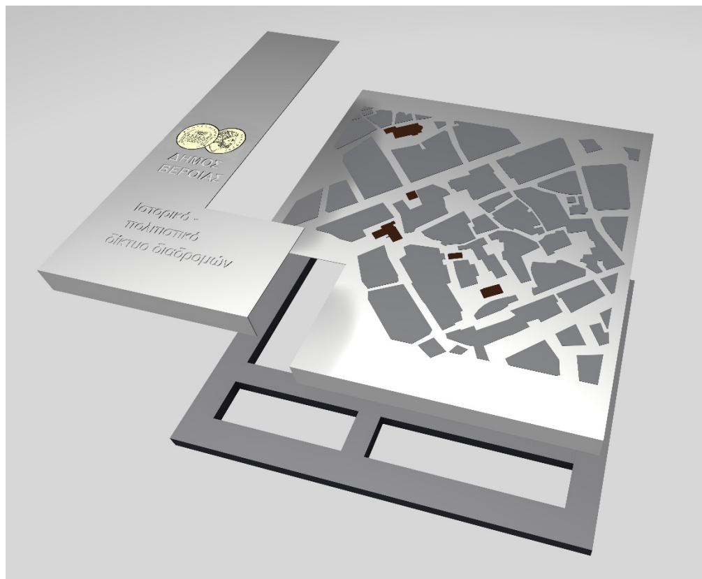
Εικόνα 14: Κεκλιμένη πινακίδα, ανάλυση της κατασκευαστικής της δομής.
